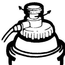
La valvola del regolatore d'aria è ideato per il collegamento alle bombolette d'aria. Può regolare l'aria tra i 15 e i 50 PSI (da 1 a 3 bar). Per lavori più ampi e operazioni di vaporizzazione più prolungate si consiglia di collegare il prodotto ad un piccolo compressore.
