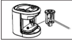
6. Nel caso una mina ostruisce le lame, aprire il contenitore e utilizzare l'estremità della matita con punta rotta per far scivolare la mina verso la parte più larga della lama e favorirne la fuoriuscita. Non utilizzare oggetti metallici in quanto potrebbero danneggiare le lame del temperamatite. Non inserire alcun tipo di oggetto nel foro presente sul lato del temperino in quanto non ha una specifica funzione.
