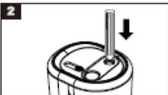
3. Per matite di diametro 6-8mm inserire la matita nel foro più piccolo.
