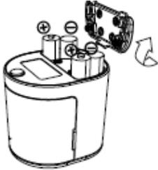
1. Inserire le batterie (4AA x 1.5V) rispettando la corretta polarità (vedi paragrafo “BATTERIE”).
